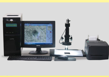
Elektronenmikroskopische Messung des Kerbdurchmessers (Ultimheat Labor)
